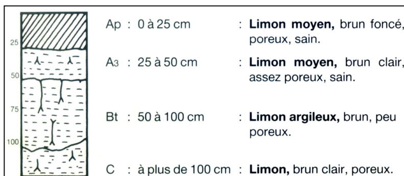
Figure 5 : Coupe de sol-type au niveau du site d'étude
